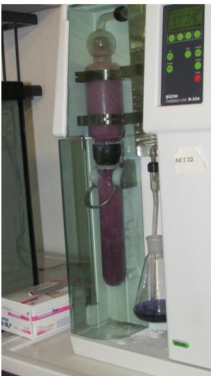
(figura 9) l'indicatore è diventato viola e l'aggiunta di soda sta per essere bloccata.
