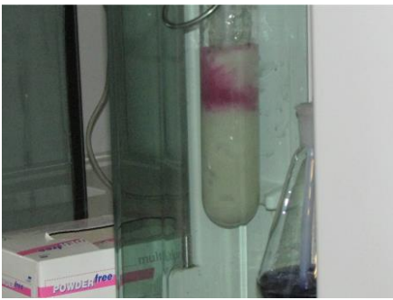
(figura 8) campione in esame con soda e fenolftaleina (la reazione acido-basico)
